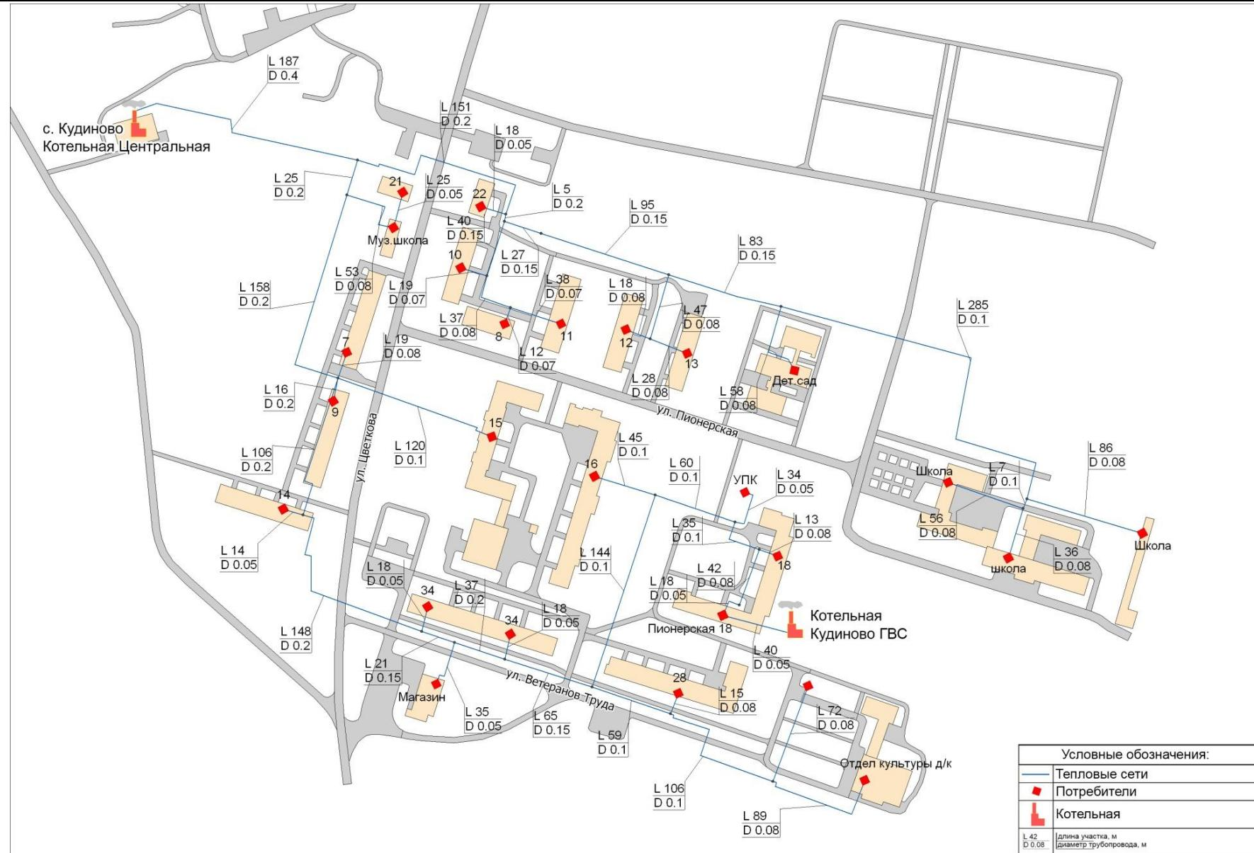
**Рисунок 1.3.1 – Схема тепловых сетей котельной Центральная и котельной ГВС жилого дома**
